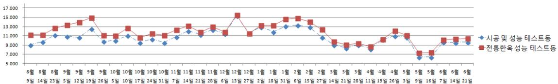
그림 382. 시공 및 성능 테스트동과 전통한옥 성능 테스트동의 함수율 비교
