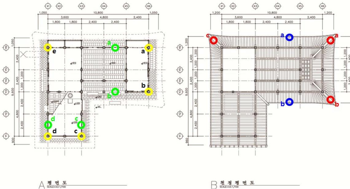
그림 7. 전통한옥 성능 테스트 동 처짐 측정위치
